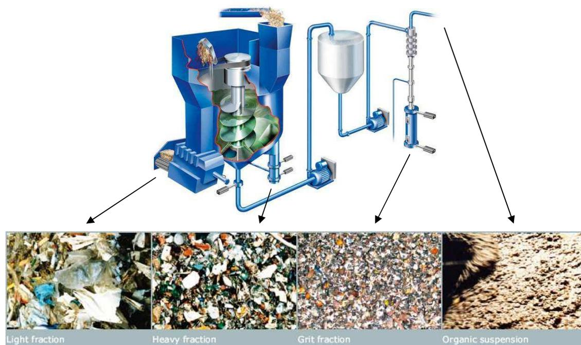
Figure 8.7 Prétraitement hydromécanique (Source : BTA international<sup>25</sup>)
