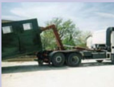
Le projet de rénovation EDIL-GENGA est un exemple de tri complexe en 3 fractions plastiques (PVC, polyéthylène et polypropylène) dans des conteneurs divisés en 3 parties, avec utilisation d'un point de regroupement sur le site de l'entrepreneur.
